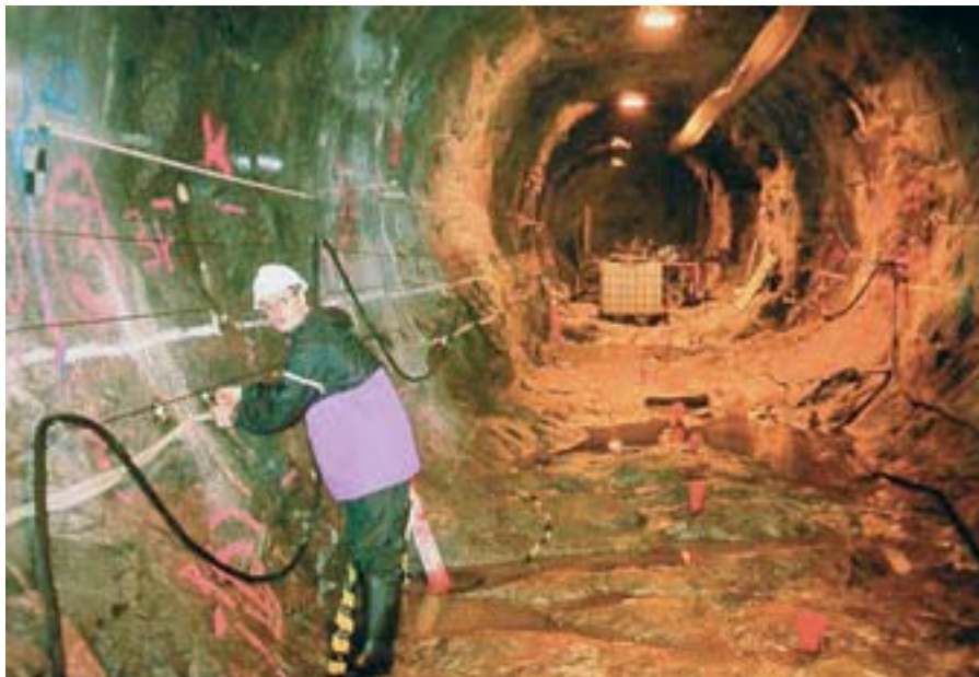
▲ Geoelektrische Messungen im HRL ÄSPÖ Geoelectrical measuring in the ÄSPÖ HRL
